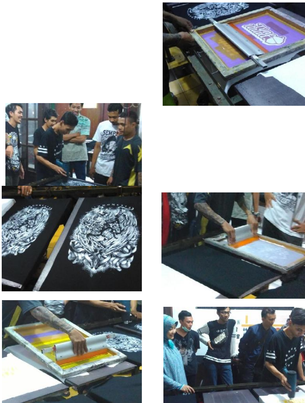
Gambar 10. Proses sablon raster warna putih di kaos hitam
