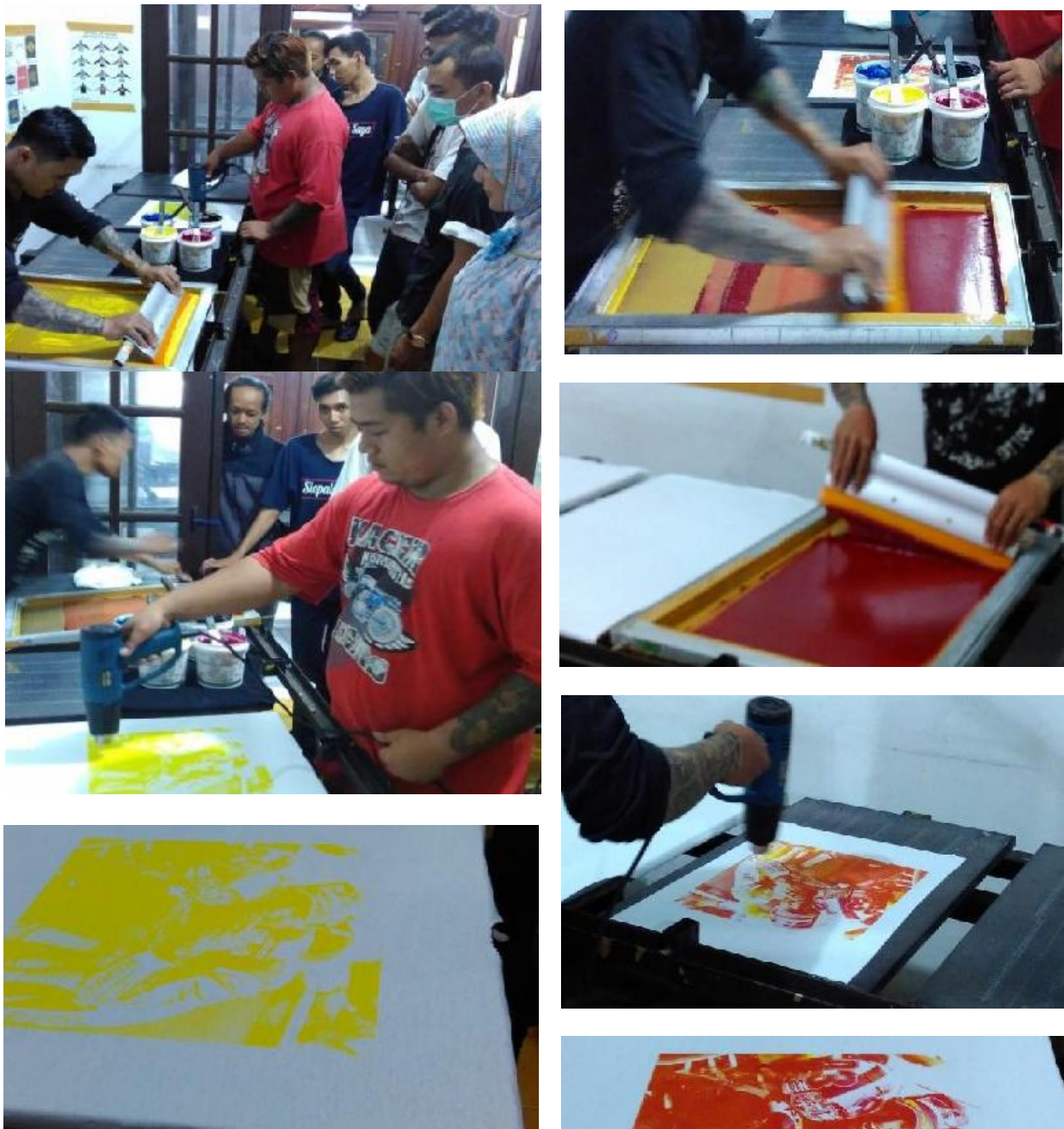
Gambar 7. Proses sablon CMYK warna pertama Proses sablon CMYK warna kedua
